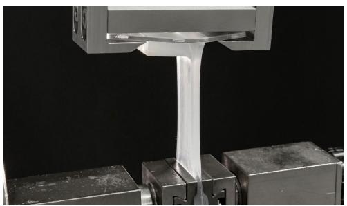
Tests zeigen, dass der neue selbsthaftende Siliconkautschuk ELASTOSIL® LR 3078 des Chemiekonzerns WACKER auf Polycarbonat ohne Vorbehandlung exzellent haftet. Das ermöglicht eine effiziente Großserienproduktion von Polycarbonat-Silicon-Verbundbauteilen, beispielsweise in der Medizintechnik. (Foto: WACKER)
