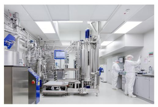
Blick in die Produktion der Wacker Biotech GmbH in Jena: Mit Hilfe modifizierter *E. coli*-Bakterien werden in Fermentern Pharmaproteine produziert. (Foto: WACKER)
