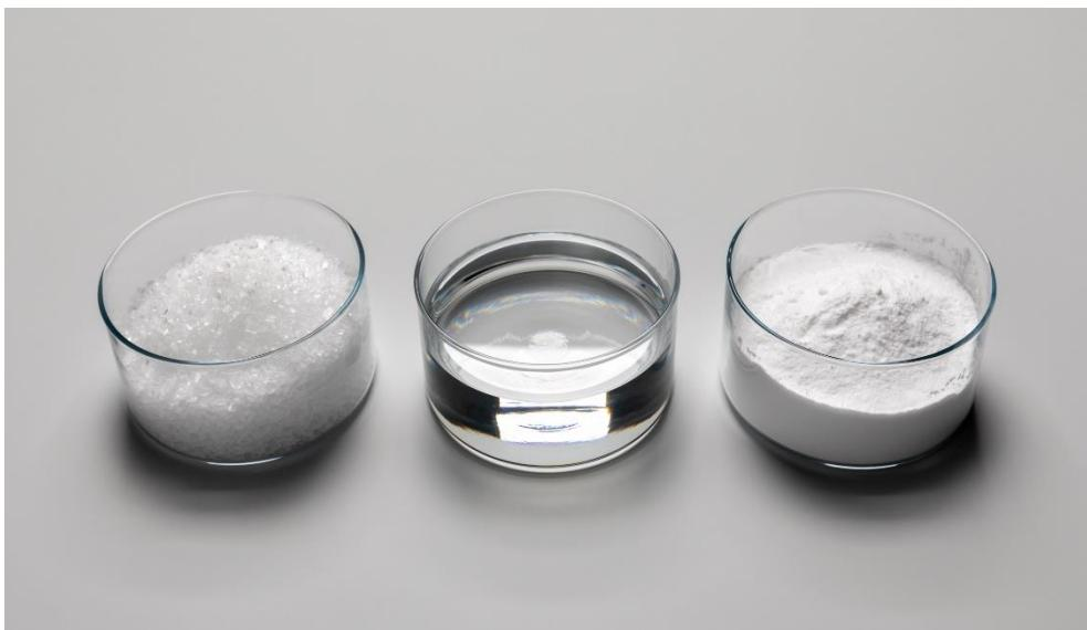
Auf der CWIEME Berlin zeigt WACKER unter anderem schwer brennbare Siliconharze für elektrotechnische Anwendungen. SILRES® Siliconharze sind in gekörnter (SILRES® MK SCHUPPEN), flüssiger (hier: SILRES® H60) und in Pulverform (SILRES® MK PULVER, SILRES® H44) erhältlich.
