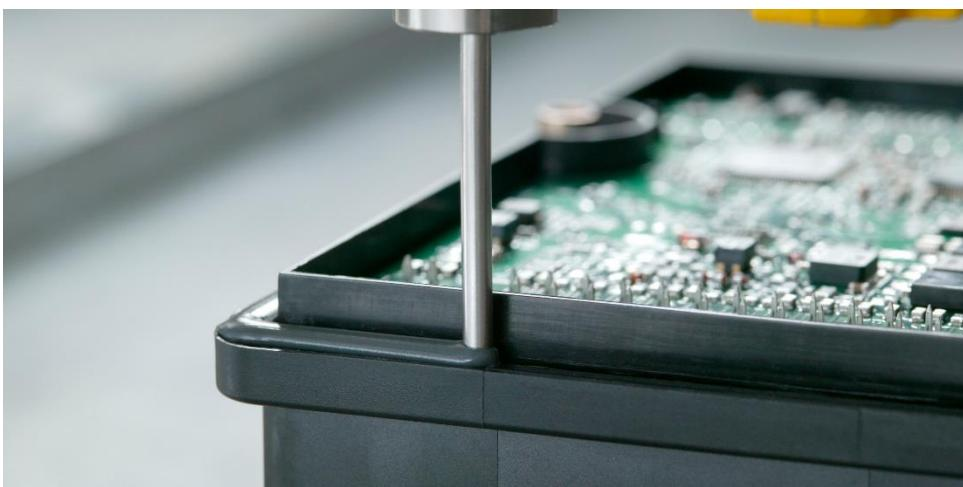
Dichtraupe aus ELASTOSIL® N 9111. WACKER zeigt auf der CWIEME Berlin den vielseitig einsetzbaren Kleb- und Dichtstoff aus Siliconkautschuk. Er vulkanisiert bei Raumtemperatur und besitzt eine exzellente Hitzestabilität. Da er die Brandschutznorm UL94 V-0 erfüllt, wird er auch zur Abdichtung elektrischer Anschlüsse in sicherheitskritischen Bereichen eingesetzt. (Photo: WACKER)
