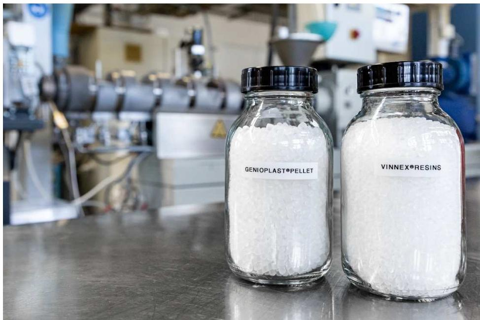
Eine ideale Kombination für Verarbeiter von Biokunststoffen: Das silicon-basierte Prozesshilfsmittel für Thermoplaste und technische Kunststoffe GENIOPLAST® (links) und das auf der Polyvinylacetat-Technologie basierende Additivsystem VINNEX® verbessern die Verarbeitbarkeit und Produkteigenschaften von Biokunststoffen. (Photo: WACKER)
