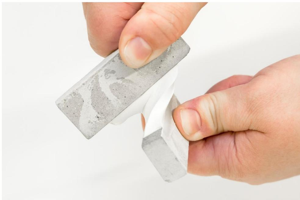
Organofunktionelle Silane kommen unter anderem bei der Formulierung hochelastischer Spezialkleber für Bauanwendungen zum Einsatz. (Foto: Wacker Chemie AG)
