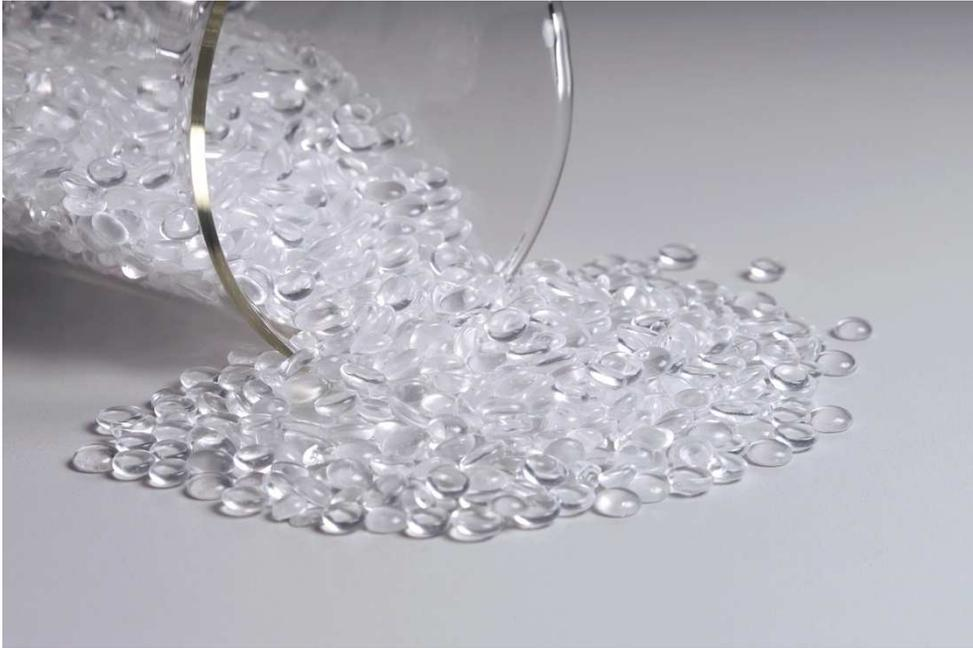
VINNAPAS® Festharze. Es handelt sich dabei um thermoplastische Polyvinylacetate (PVAc). Solche filmbildenden Produkte werden unter anderem als Anti-Schrumpf-Additive zur Herstellung von Faserverbundwerkstoffen und zur Formulierung von Klebstoffen und Beschichtungen eingesetzt.
