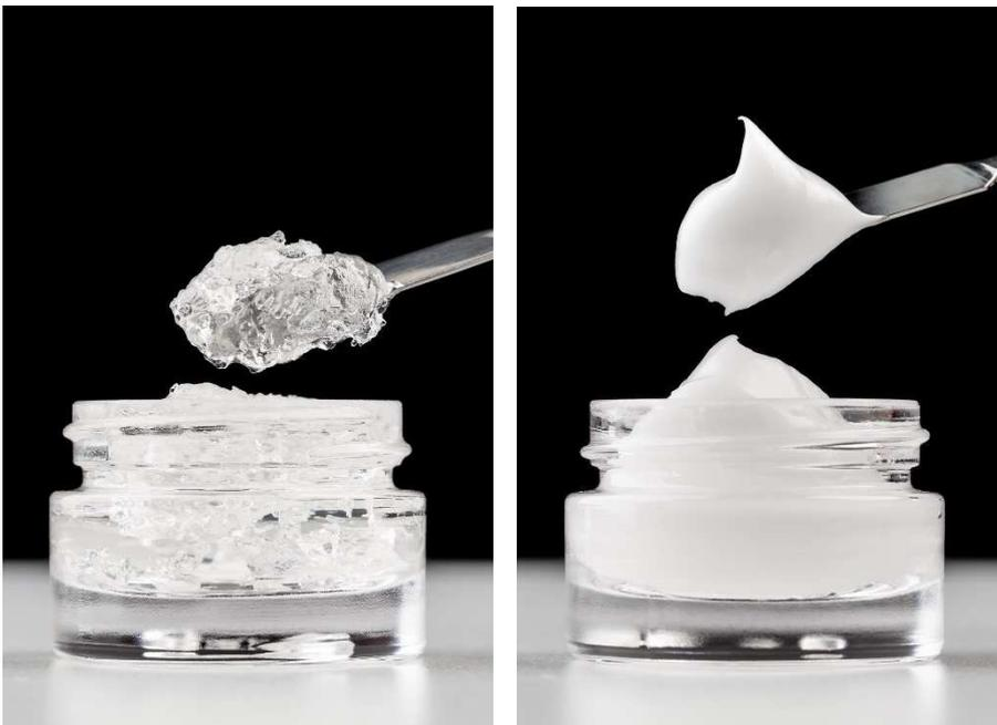
Siliconharzelastomer-Gele lassen sich gewöhnlich nicht mit Wasser mischen. Bei BELSIL® REG 1103 B ist das anders. Das transluzente, farblose Produkt (Bild links) ist wasserverträglich. Wird es mit Wasser gemischt, entsteht eine standfeste Creme, die sich durch eine körperreiche und homogene Textur auszeichnet (rechts). (Fotos: Wacker Chemie AG)
