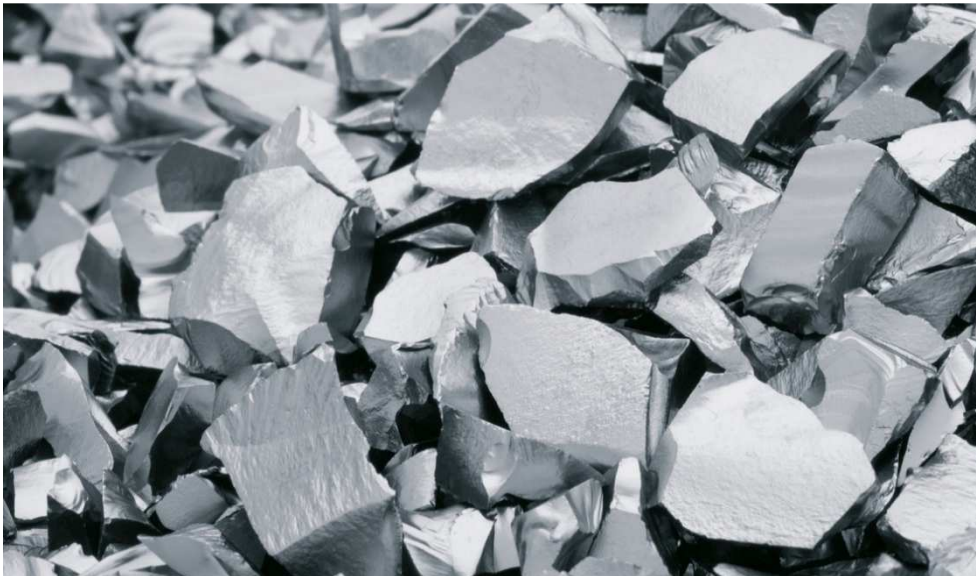
Polykristallines Silicium des Münchner Chemiekonzerns WACKER. Aus dem hochreinen Material werden Siliciumwafer für die Solar- und Computerindustrie hergestellt. (Photo: WACKER)
