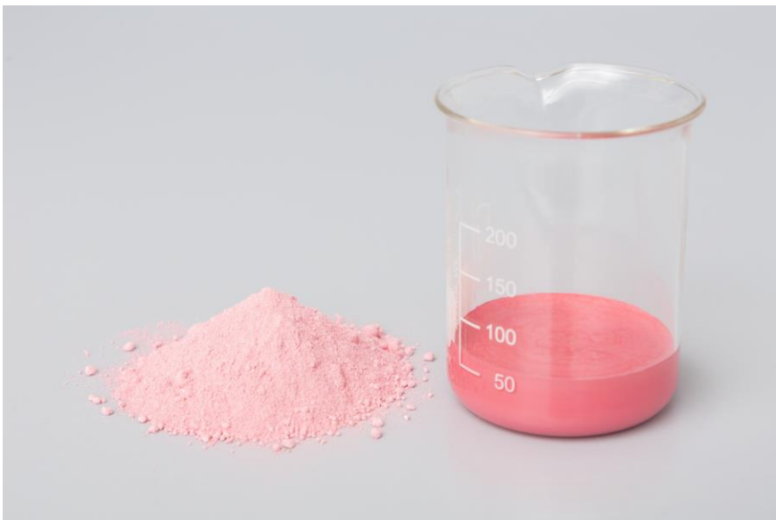
Farbe mit NEXIVA® in Pulverform (links) und mit Wasser redispersiert (rechts). (Foto: Wacker Chemie AG)
