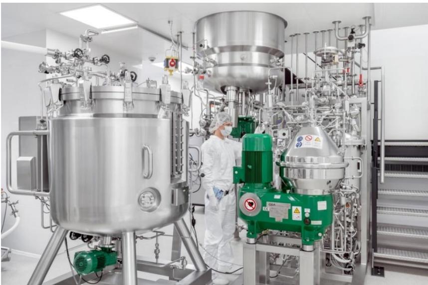
In Edelstahlstanks, sogenannten Fermentern, produzieren Bakterien bei Wacker Biotech die gewünschten Wirkstoffe (Foto: WACKER).
