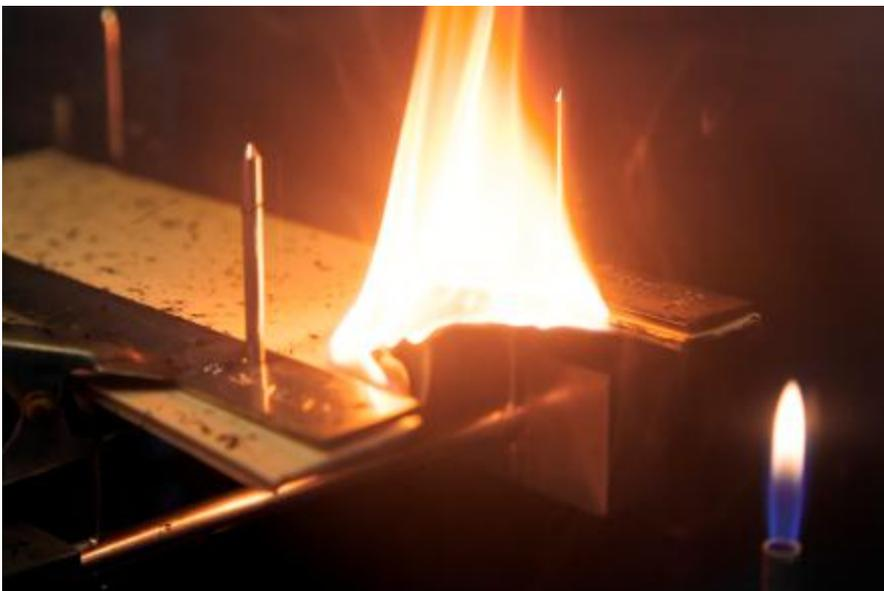
Brennkammer-Test: Filme mit VAE- und SB-Bindemitteln werden im WACKER-Teppichlabor in Burghausen geprüft. Die Tests zeigen, dass spezielle VAE-basierte Filme im Brandfall selbst erlöschend sind (oben), wohingegen Filme mit SB unter Entwicklung von schwarzem Rauch verbrennen (unten). VAE-basierte Bindemittel ermöglichen somit Formulierungen, die weniger Flammschutzadditive benötigen (Fotos: Wacker Chemie AG).
