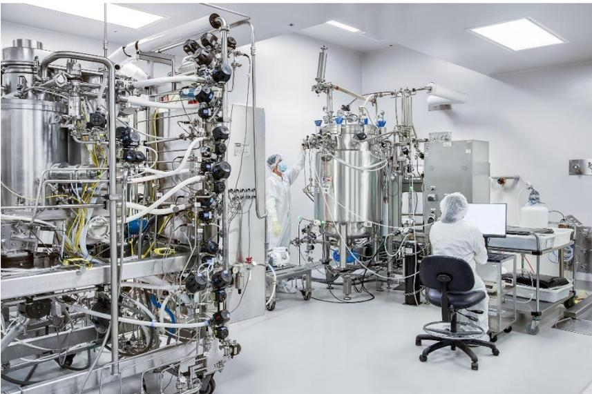
Als Auftragshersteller betreibt Wacker Biotech US Inc. in San Diego eine spezialisierte Fermentationslinie zur Herstellung und Aufreinigung von Plasmid-DNA (Foto: WACKER).
