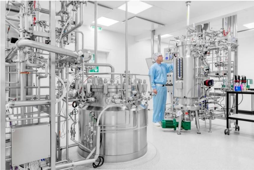
In Edelstahlstanks, sogenannten Fermentern, produzieren Bakterien bei Wacker Biotech in Halle Pharmaproteine. Mit dem Ausbau zum mRNA-Kompetenzzentrum, das 2024 in Betrieb gehen wird, kommt eine neue Technologie an den Standort (Foto: WACKER).
