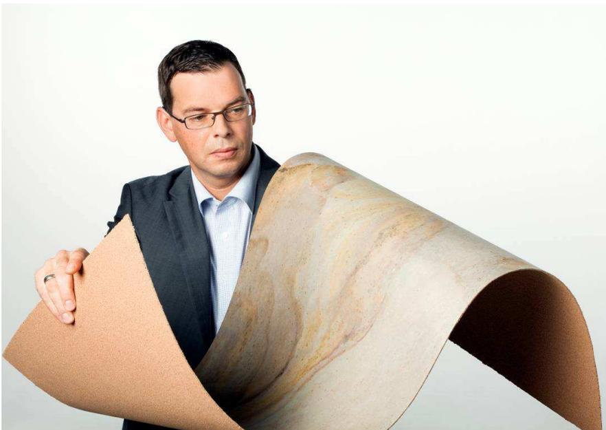
Hauchdünne und flexible Schiefer-Kork-Platte: Auf der Basis von Naturkork, indischem Schiefer und WACKERs innovativem VINNEX®-Bindepulver entstehen neuartige Boden- und Wandbeläge (Foto: Wacker Chemie AG).
