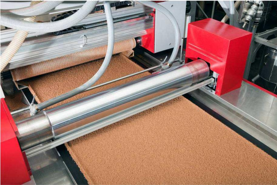
In einer so genannten Doppelbandpresse werden unter Druck und Temperaturen von rund 180 Grad Celsius die Korkschichten mit den hauchdünnen Schieferplatten verbunden (Foto: Wacker Chemie AG).
