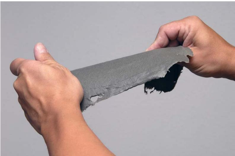
Dichtungsschlämmen mit VINNAPAS® sind äußerst flexibel und elastisch, leicht und dünn aufzutragen. Dadurch lassen sie sich besonders gut unter Fliesen anwenden, etwa in Bädern und Wellnessbereichen, oder als Beschichtung von Kanälen, Leitungen und Kellern (Foto: Wacker Chemie AG).
