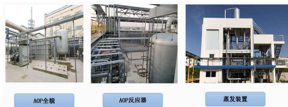
图 6.3.3-10 AOP+二效蒸发处理工艺试验案例废水处理现场照片
