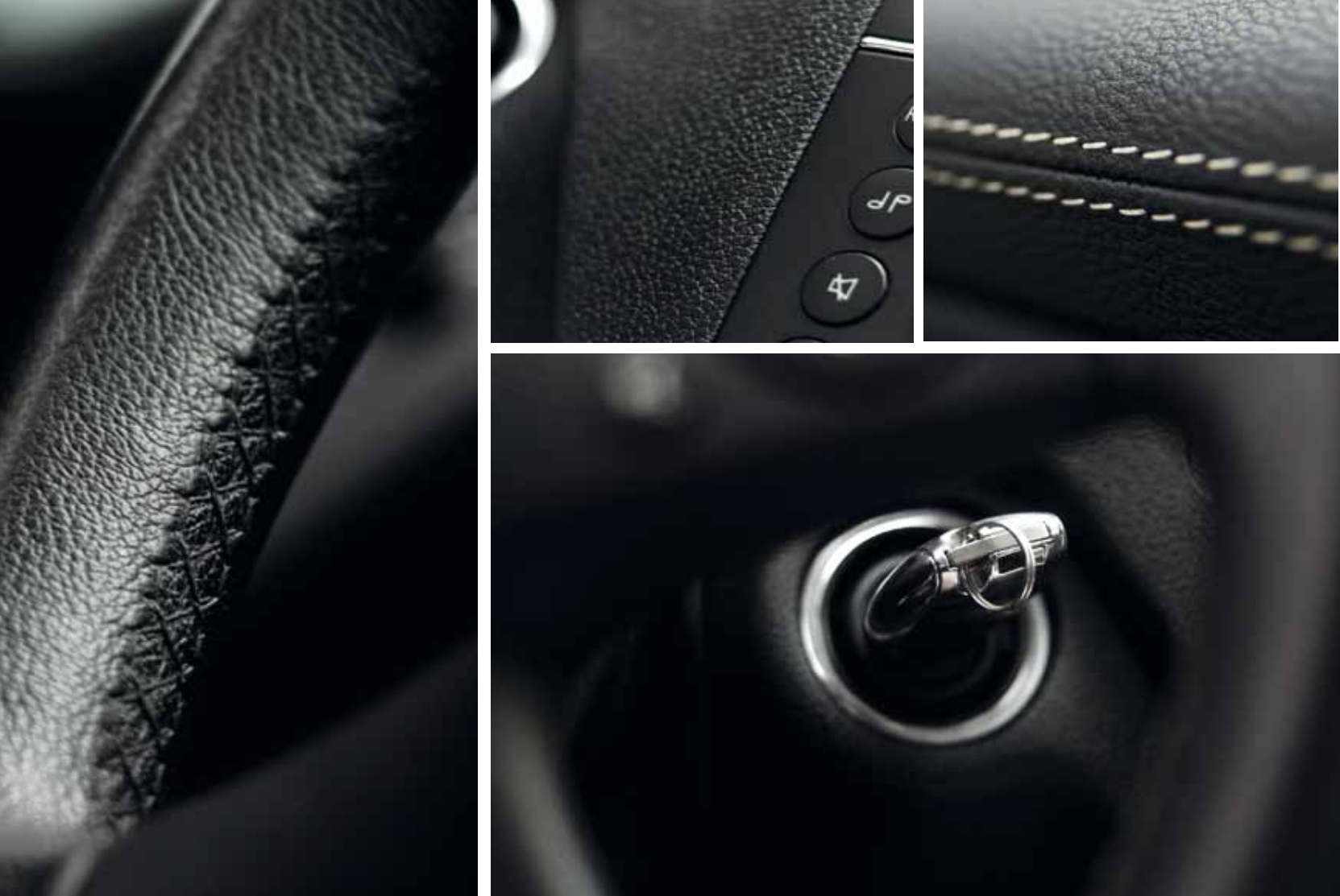
Geschäumte und mit Additiven veredelte Kunststoffe und Lederimitate sorgen für die gewünschte – optische und haptische – Qualitätsanmutung im Autoinnenraum.
