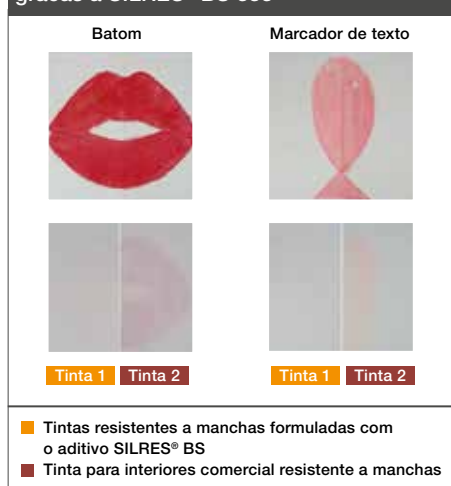
Figura 3: Melhor resistência a manchas graças a SILRES® BS 333
